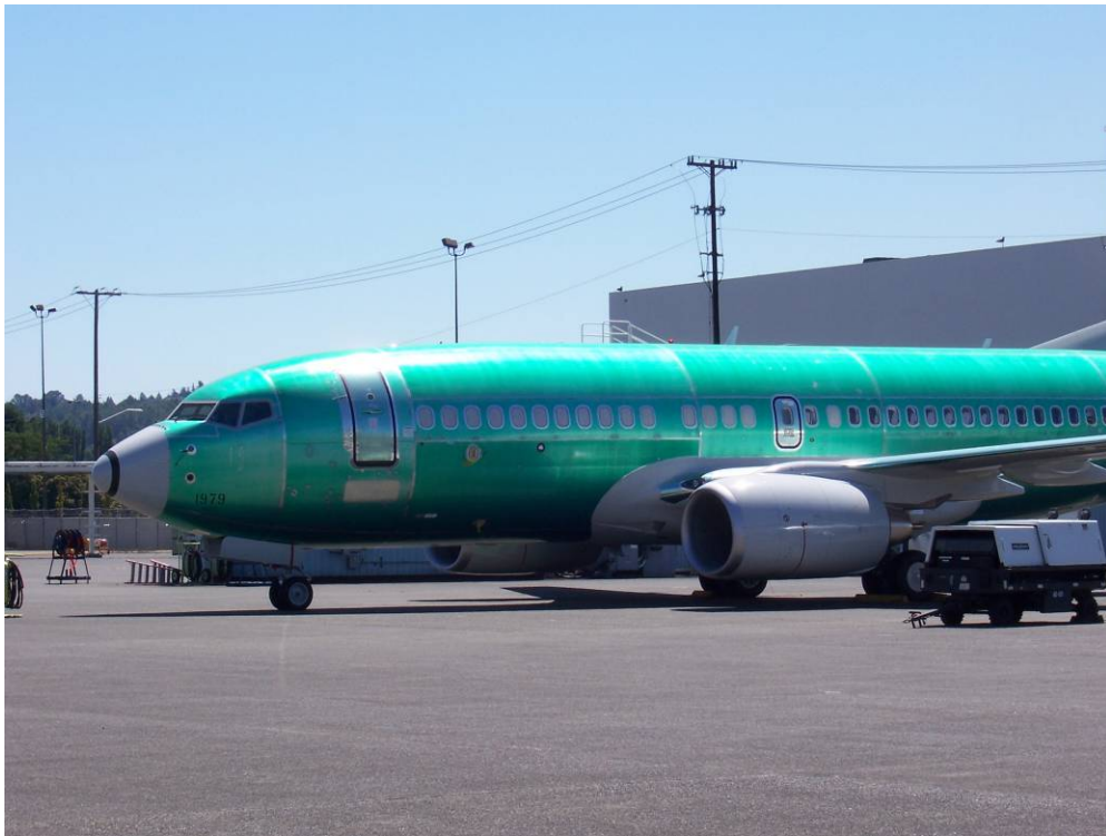
Egy vadonat új Boeing 737-es zöld fóliába csomagolva. Ezeket a repülőket Seattle-ben gyártják.
